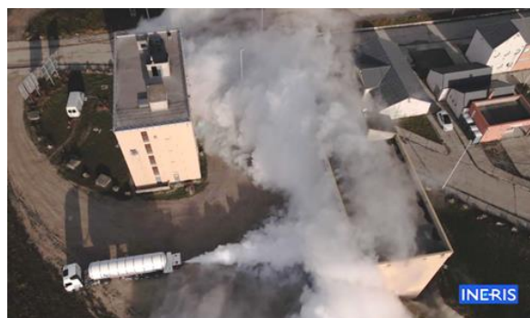
Figure 1 : Rejet de CO 2 impactant un bâtiment grande hauteur durant les essais Cenzub
