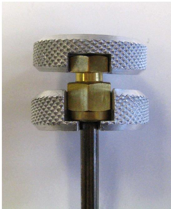
*Photo 3 : positionnement de la paire d'outils pour ouvrir le tube*
