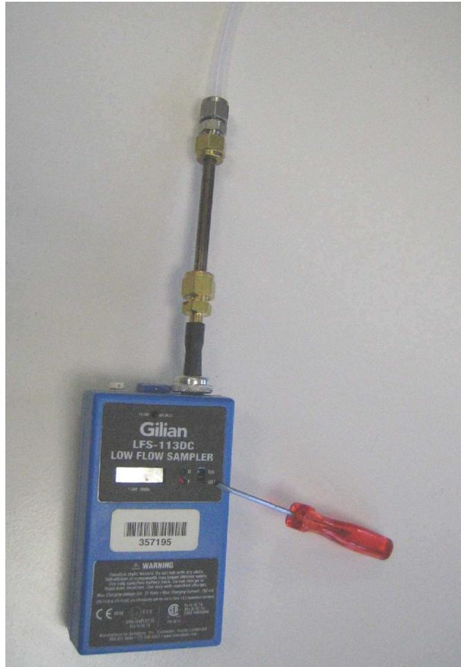
*Photo 6 : déclenchement de la pompe pour démarrer ou arrêter le prélèvement*
