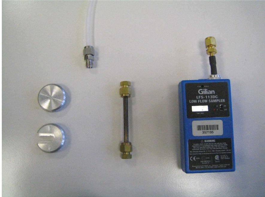
*Photo 2 : ensemble du matériel (outils, tube Téflon, tube COV, pompe Gillian)*
