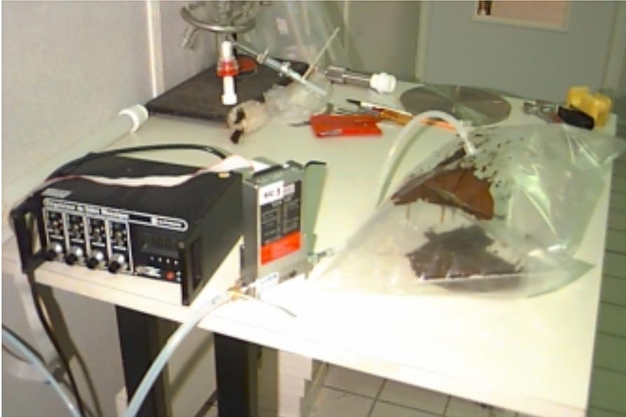
Figure 2 : Gonflage d'un sac Tedlar à l'air comprimé (photo CSTB)
