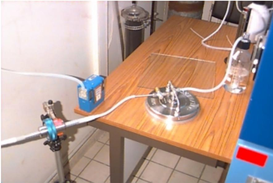
Figure 5 : Ligne de prélèvements pour HAP en sortie de la cellule FLEC (photo CSTB)
