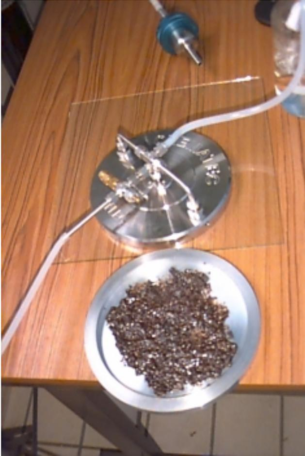
Figure 4 : *Echantillon n° 3 réf. CHEN 00CS18 dans le support d'échantillon et la cellule FLEC (photo CSTB)*
