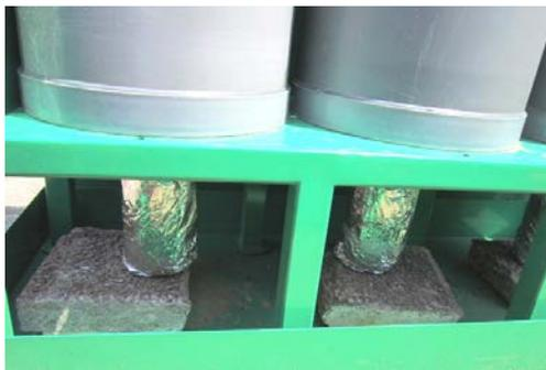
Collecte des lixiviats sous les colonnes dans des flacons de 1 L recouvert de papier aluminium
