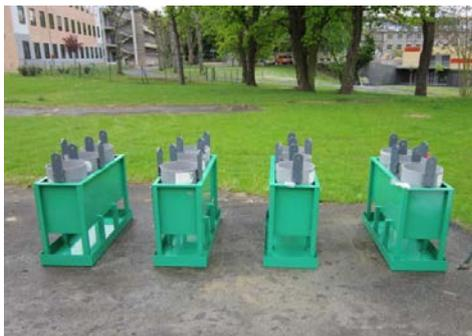
Mises en place des 12 colonnes de sol sur 4 rangées
