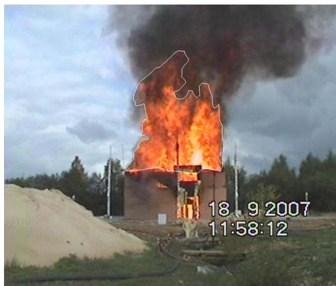
Figure 31 : Formes et surfaces des flammes lors de l'un des essais à moyenne échelle
