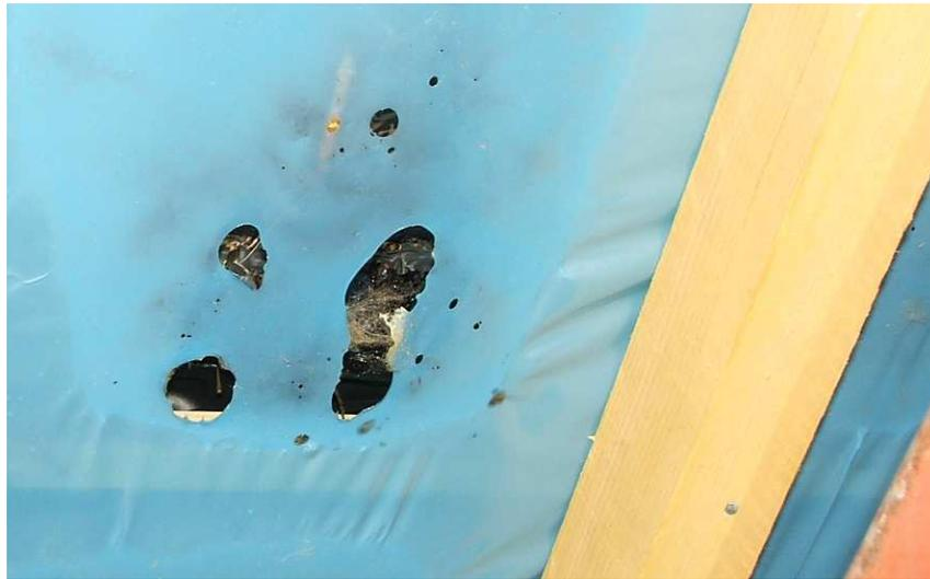
Figure 35 : Vue de dessous d'une toiture sur laquelle a été installé une éprouvette de panneau photovoltaïque selon la configuration de type 5.
