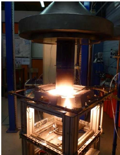
*Figure 28 : Essais de combustion d'une cellule amorphes (Unisolar)*
