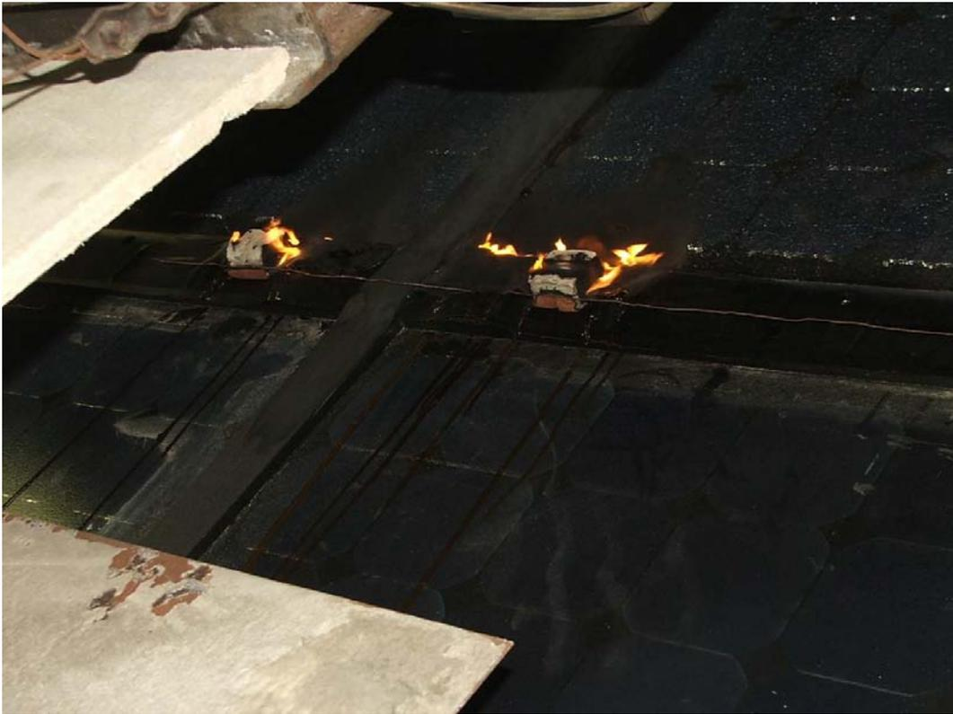
**Détail de l'inflammation superficielle à 15 minutes d'essai**
