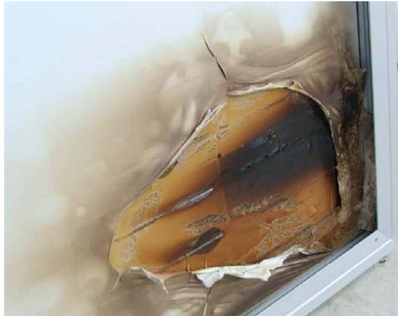
*Figure 33: Vue de dessous du panneau photovoltaïque d'une éprouvette de type 2.*
