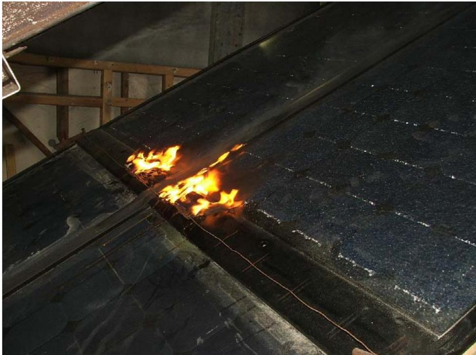
**Détail de l'inflammation superficielle à 8 minutes d'essai**
