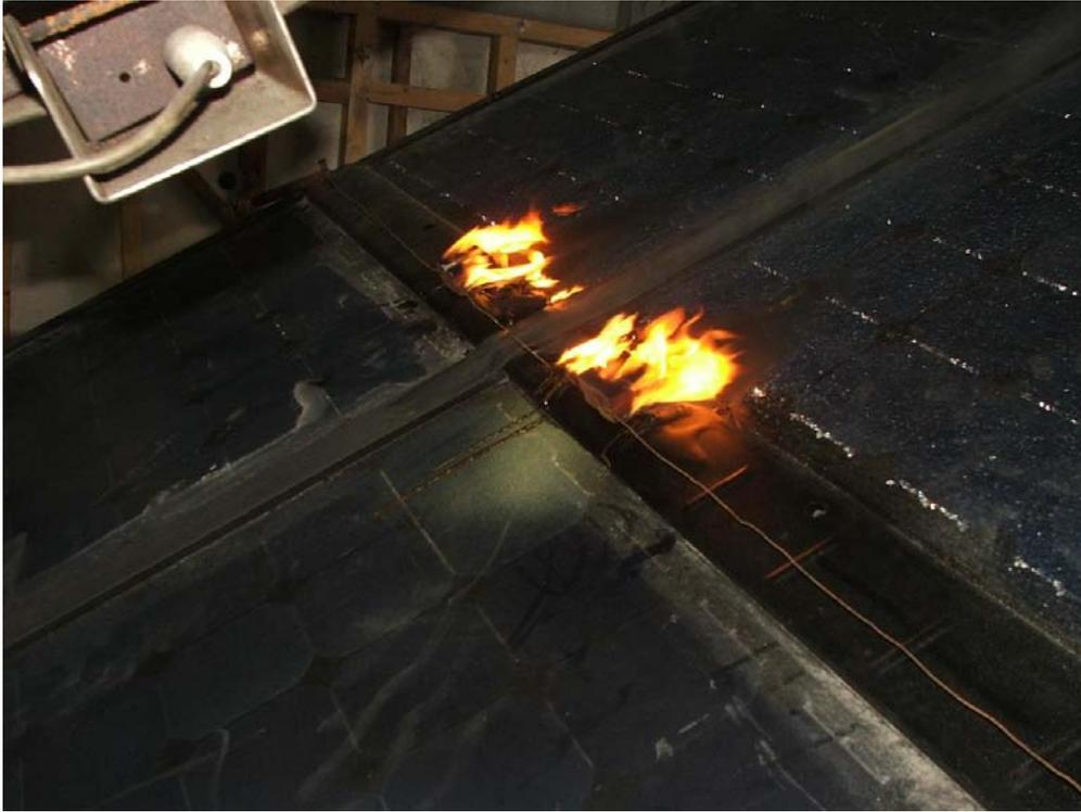
**Détail de l'inflammation superficielle à 6 minutes d'essai**
