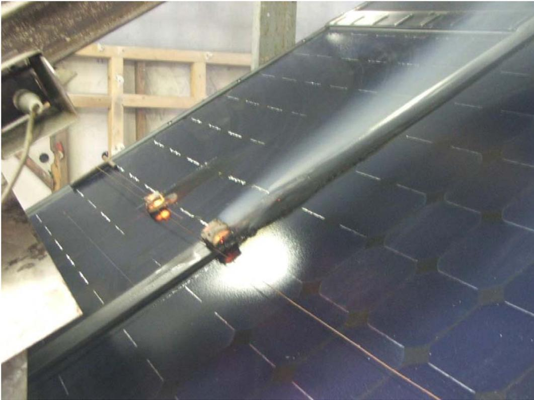
Détail de l'affaissement d'un module à 16 minutes et 20 secondes d'essai
