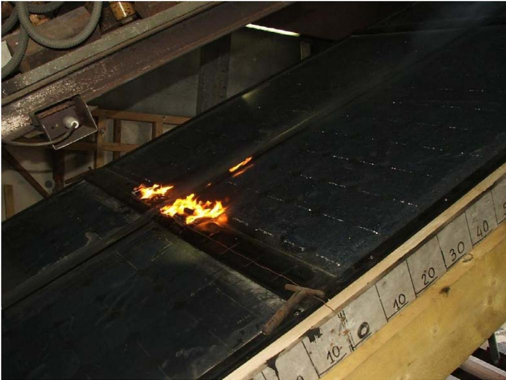
Détail de l'inflammation surfacique à 11 minutes et 30 secondes d'essai
