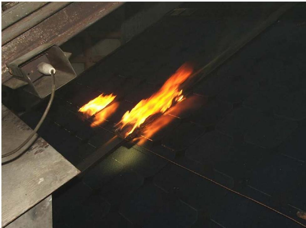
**Détail de l'inflammation superficielle à 3 minutes et 10 secondes d'essai**
