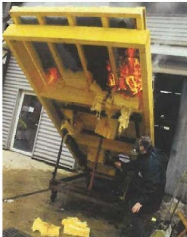
*Figure 34 : Vue de dessous d'une toiture sur laquelle a été installé une éprouvette de panneau photovoltaïque selon la configuration de type 4.*
