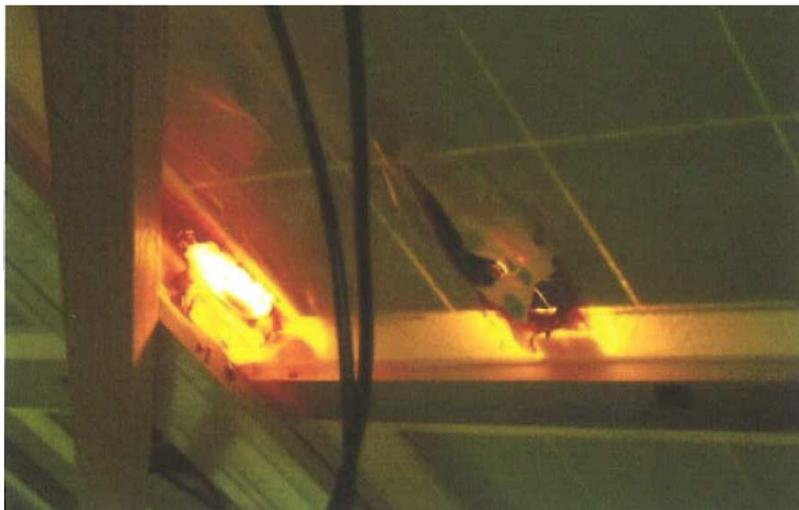
*Figure 32: Vue de dessous d'une éprouvette de type 3 après 7 minutes et 30 secondes du démarrage de l'essai.*
