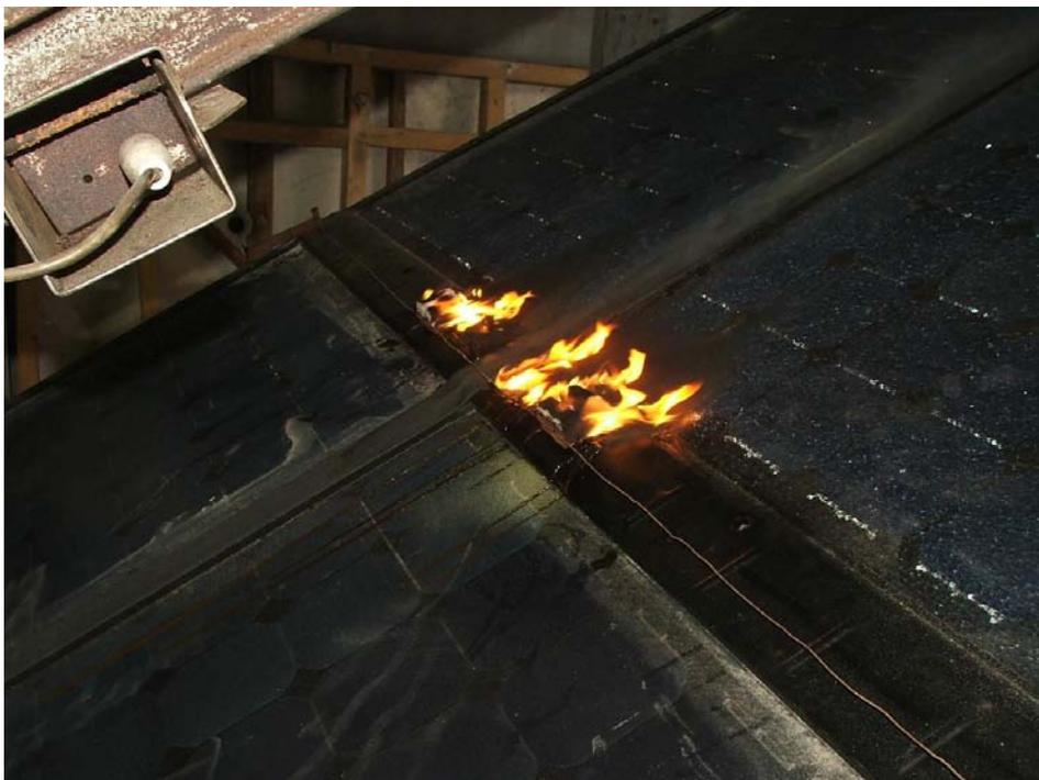
Détail de l'inflammation surfacique à 12 minutes d'essai
