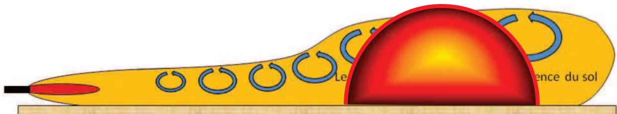
Figure 53 : Jet avec l'effet du sol
