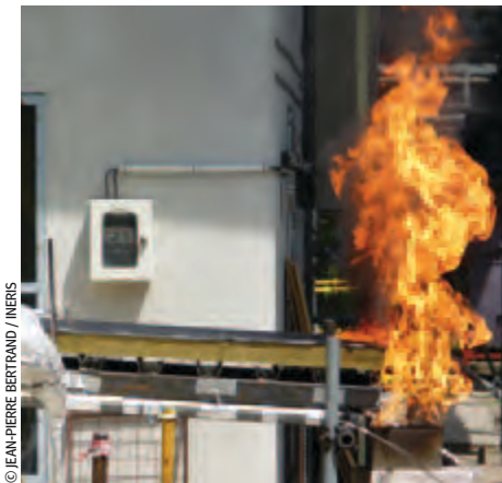
L'INERIS a reproduit une toiture industrielle de 6 m sur 1 m soumise à un feu.
