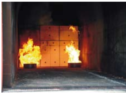
Programme BIOSAFUEL : essai à l'INERIS d'inflammation d'un mélange éthanol/essence.
