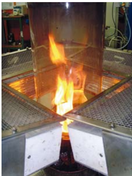
Évaluation et tests des biocarburants dans le cadre du projet ALFA BIRD : étude préliminaire à la réaction au feu de la molécule 2,5 Diméthylfurane.
