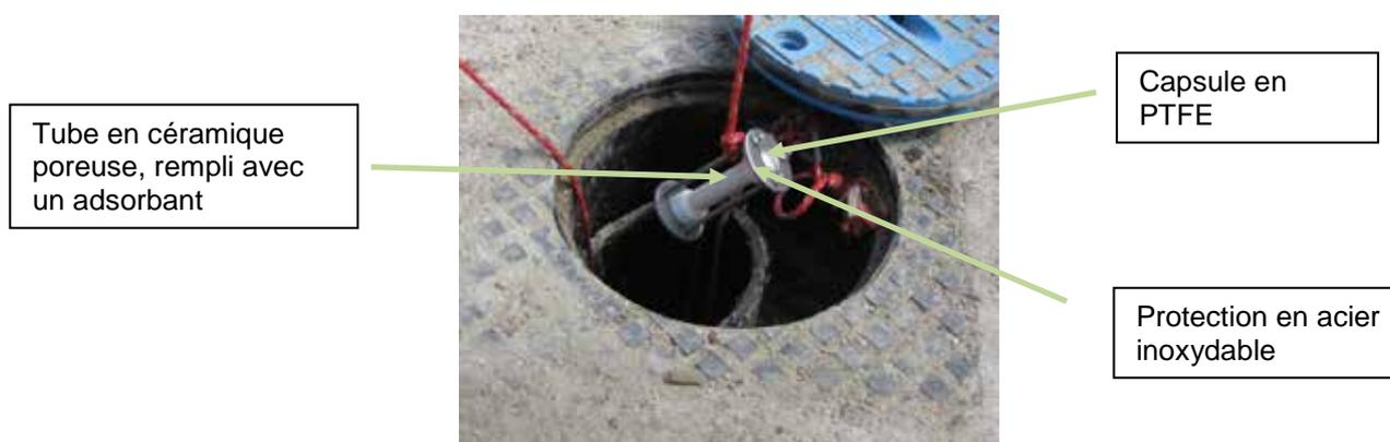
Figure 6 : Dosimètre en céramique
