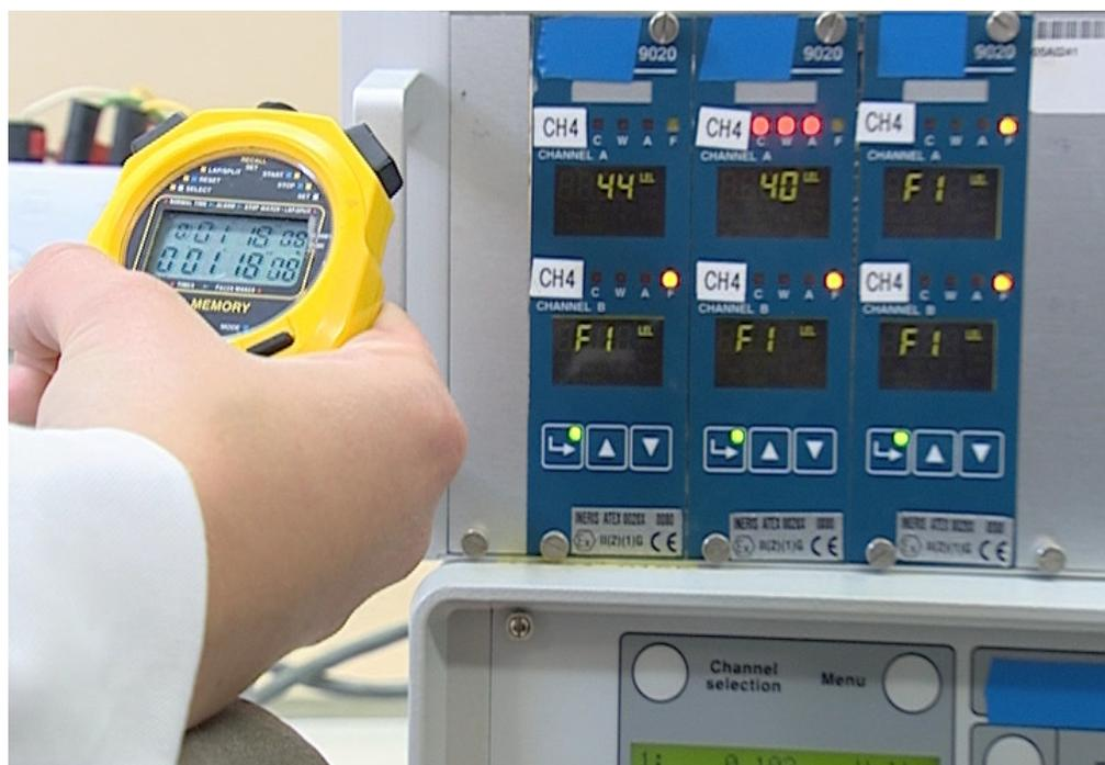
Tests de capteur de CH<sub>4</sub>, photo © INERIS 2008
