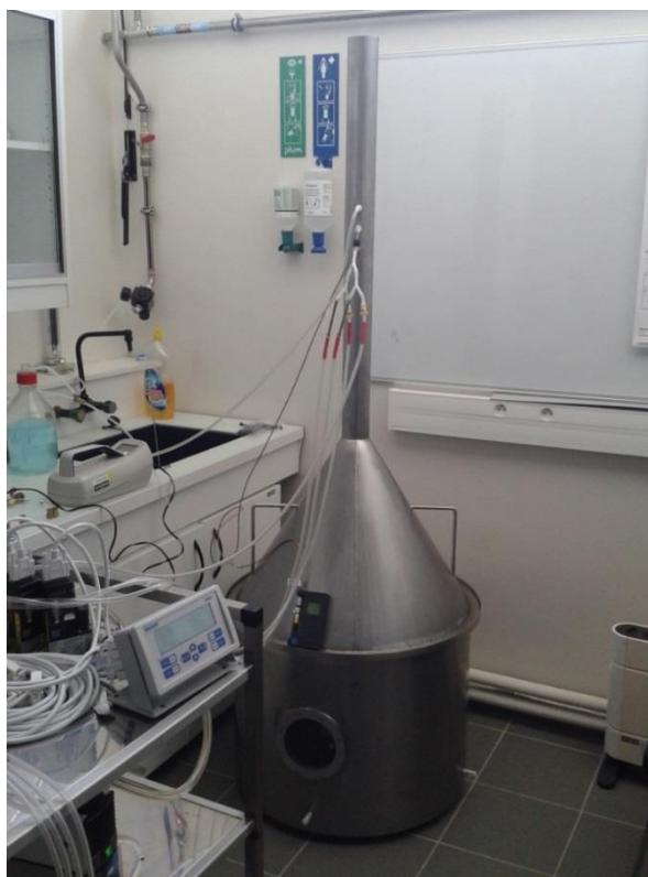
Figure 17 : Chambre d'essai « combustion » du CSTB
