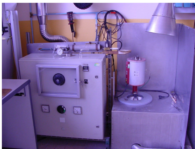
Figure 27: four de Godbert-Greenwald utilisé à l'INERIS
