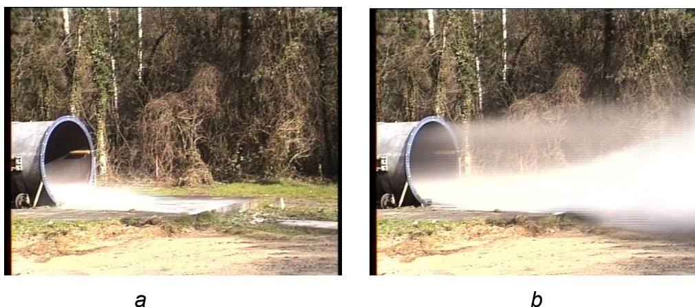
Figure 13 : dispersion d'un dépôt de poussières de calcaire à la sortie de la galerie métallique (a-phase initiale sans mélange dans l'écoulement, b-dispersion dans l'écoulement)
