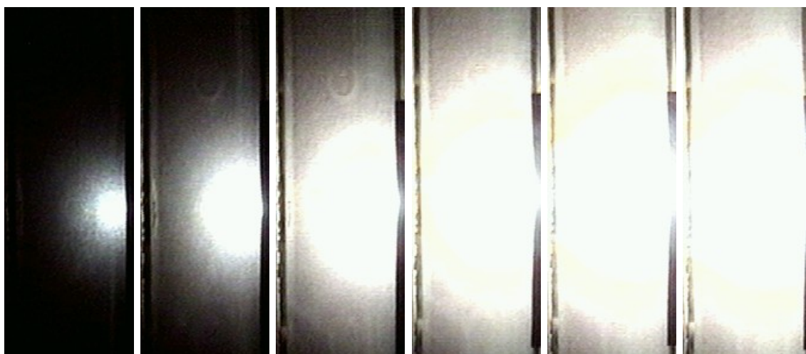
Figure 7: développement d'une flamme dans un mélange pauvre de particules d'aluminium et d'air (100 g/m 3 ; 20 ms entre images diamètre du tube = 10 cm)
