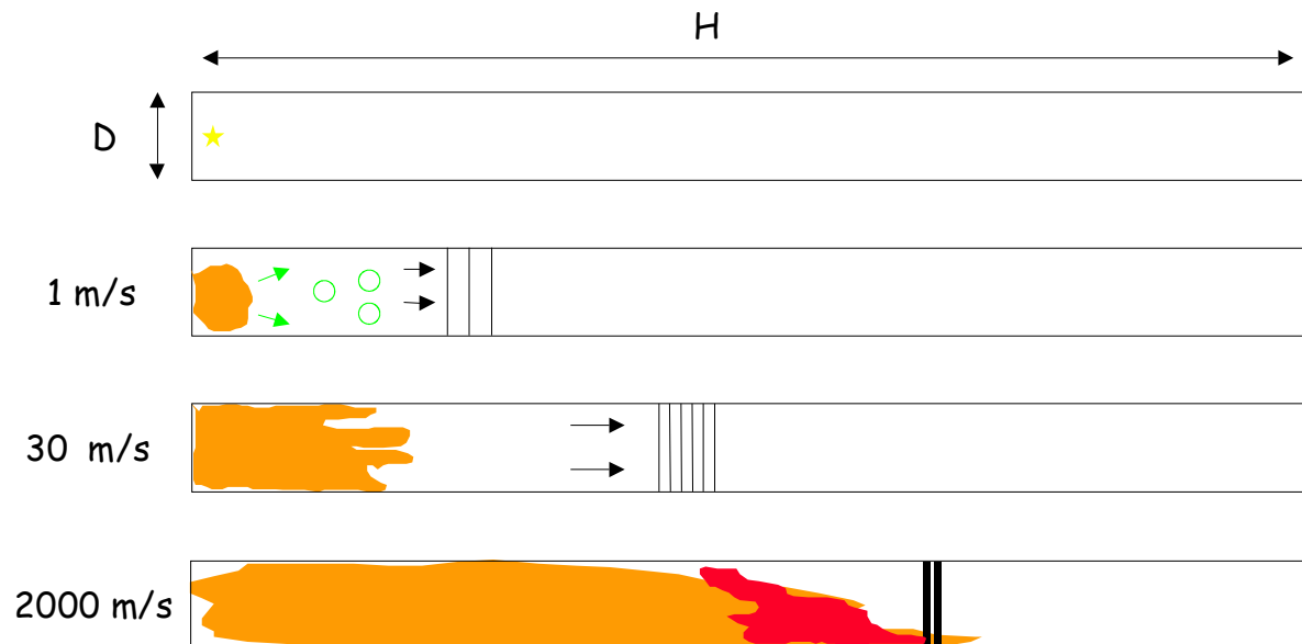
Figure 3 : histoire possible du déroulement d'une explosion
