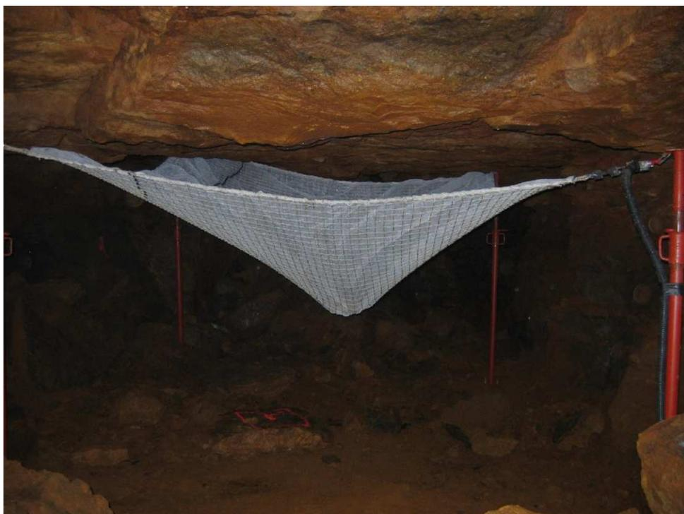
*Figure 51 : filet capteur de chute de blocs installé dans la mine de Moyeuve-Grande, au droit d'une habitation. Un capteur de traction à l'une des extrémités indique le poids accumulé dans le filet.*
