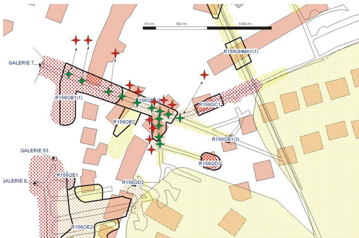
*Figure 46 : Localisation des tirs dans la mine Côte d'Hayange en exploitant une vitesse équivalente, en rais droits. Les croix vertes marquent l'origine du tir, les croix rouges la localisation.*
