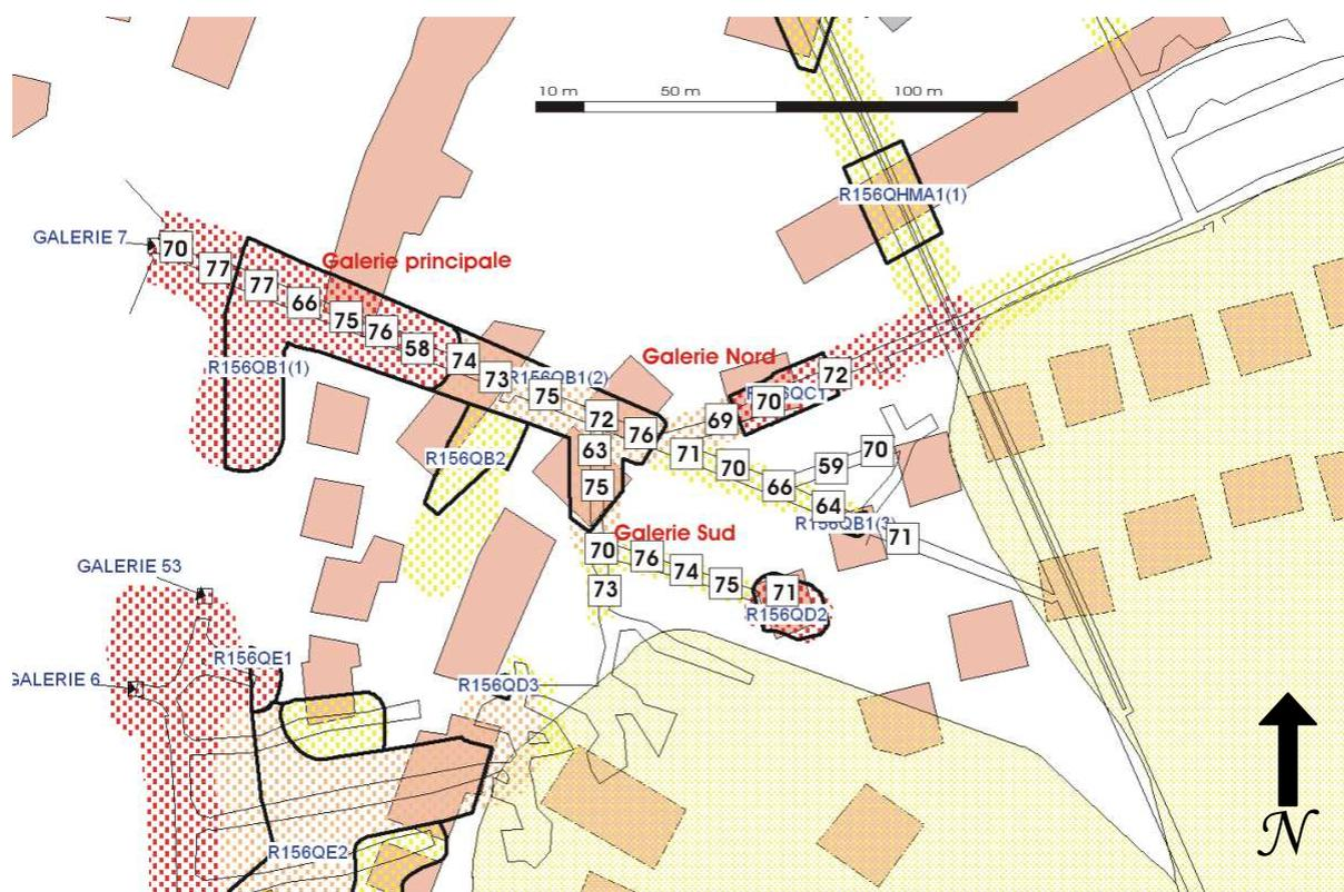
Figure 25 : Carte du bruit de fond de la mine d'Hayange (niveaux de pression acoustique en **LZeq** (dB)).
