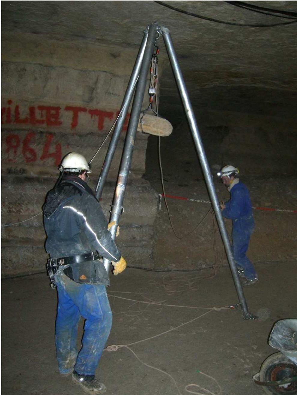
*Figure 29 : Simulation de chutes de blocs de calcaire de 50 kg. La chèvre permet de lever le bloc jusqu'à 2,50 m, les poulies divisent l'effort par 5. Une ficelle permet d'ouvrir un largueur à distance.*
