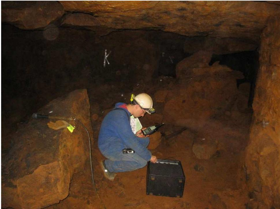
*Figure 19 : Utilisation d'une source acoustique (Sound source 4224, Bruel & Kjaer) pour la simulation de chute de blocs sur le site de Moyeuve-Grande. La source est couchée pour créer une onde acoustique homogène dans le plan horizontal.*
