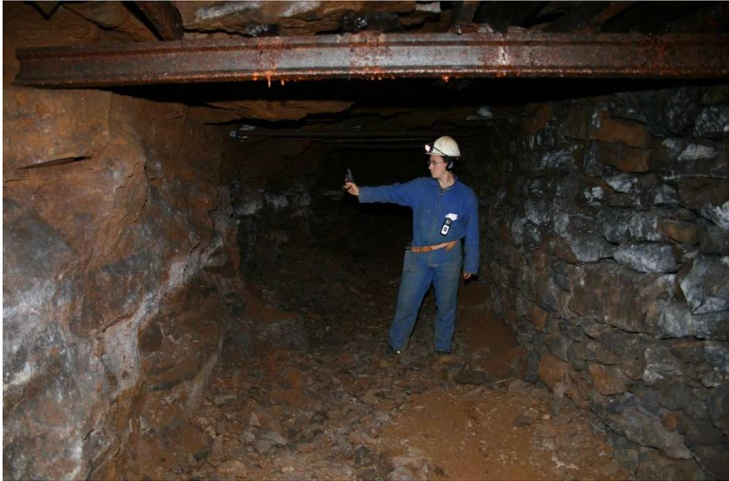
*Figure 36 : Utilisation d'un pistolet d'alarme pour la réalisation d'un zonage des temps d'arrivée des ondes acoustiques au sein de la mine de Moyeuve. Le pistolet est tenu à bout de bras pour limiter l'influence de l'opérateur.*
