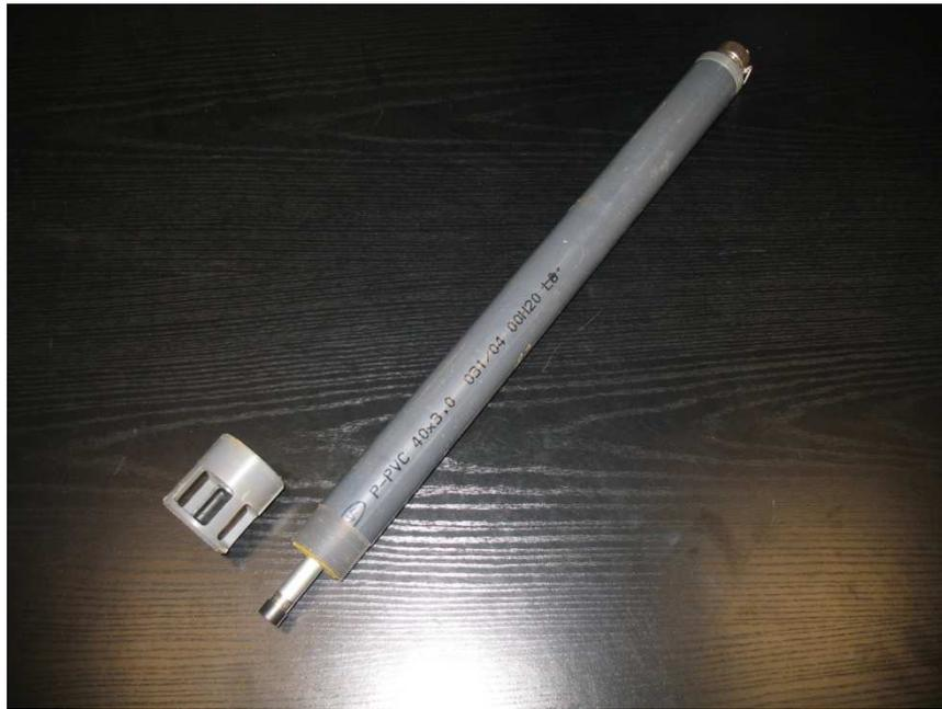
Figure 16 : Photographie d'une sonde microphonique INERIS. Le capteur se trouve à l'extrémité (basse sur la photographie) du corps de sonde qui renferme également un amplificateur.
