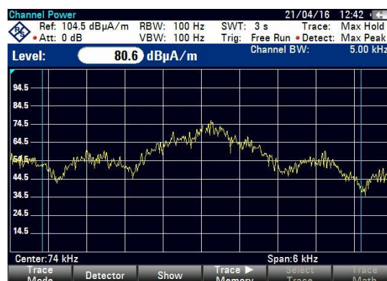
Figure 7. Mesure sur une largeur de bande de 5 kHz, à 74 kHz
