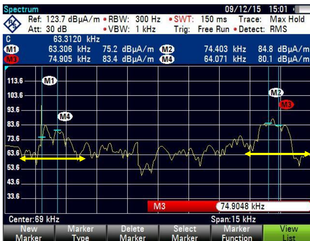
Figure 5. Mesures sur une largeur de bande de 15 kHz, à 63,3 kHz (M4) et à 74 kHz (M2)
