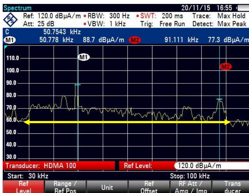
Figure 3. Signal CPL avec un compteur G3
