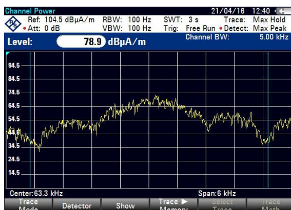
Figure 6. Mesure sur une largeur de bande de 5 kHz, à 63,3 kHz
