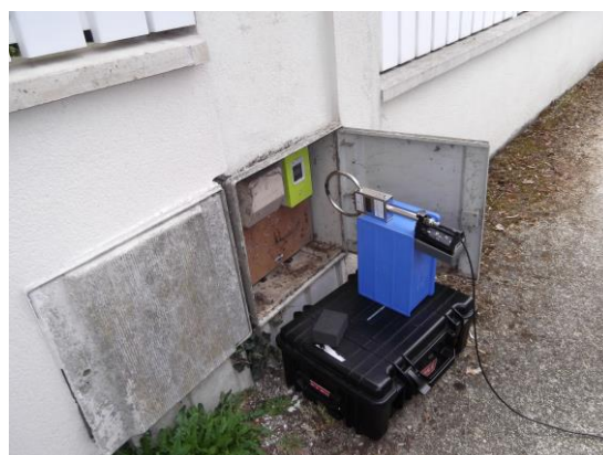
Photo 10. Champ magnétique vertical sur site
