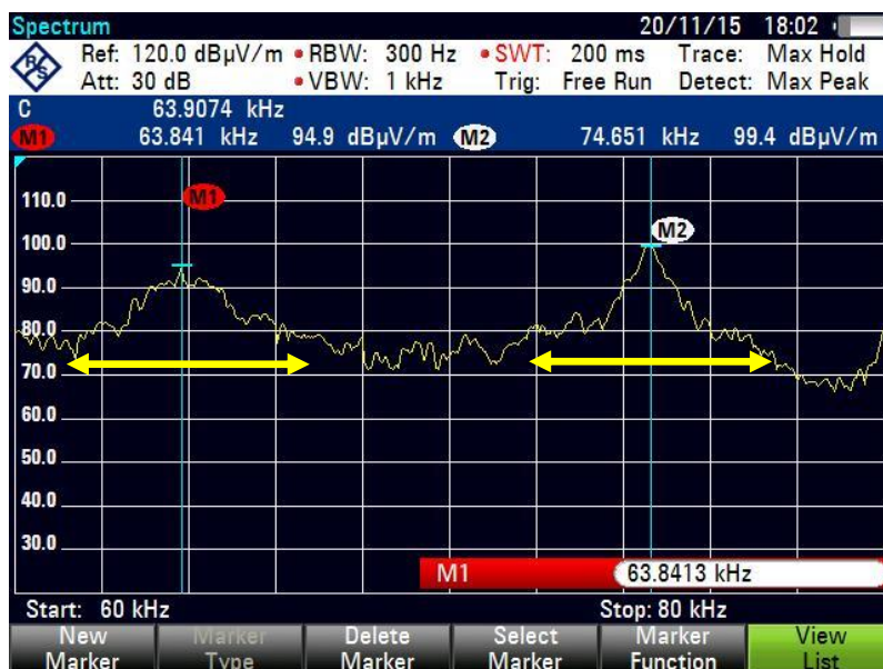
Figure 1. Signaux CPL avec un compteur G1
