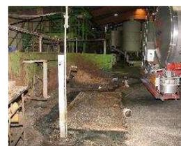
La procédure de déchargement du camion n'est pas respectée à la suite d'une panne du moteur du couvercle recouvrant la fosse la laissant ainsi ouverte. Cette cuve contient des déchets d'animaux ou de laiteries. Pendant le déchargement du camion, une grande quantité de sulfure d'hydrogène (H<sub>2</sub>S) est émise.
