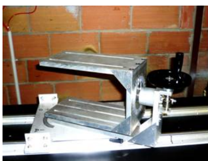
Figure 6 : Principe de la rotation d'angle \alpha (de -65^\circ à +65^\circ )
