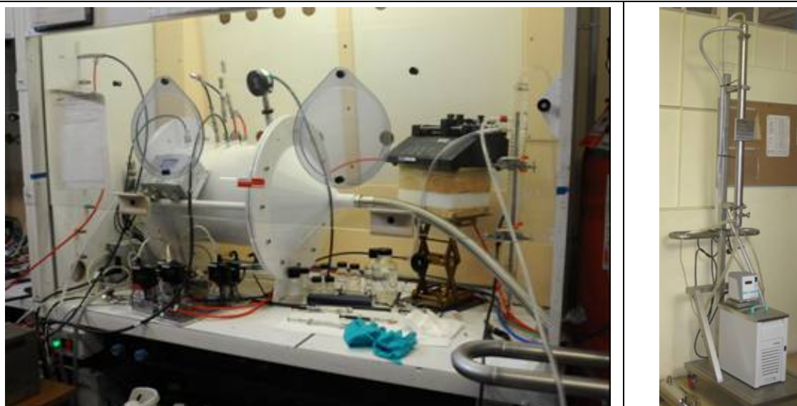
Figure 2 : Enceinte d'essais instrumentée de 30 litres en acier inoxydable et système d'humidification de l'air
