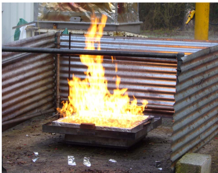
Photo 1 : Photo d'un feu de 5 litres d'éthanol
