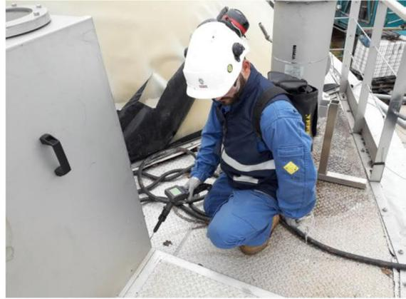
*Figure 2 : Photos de mesures de détection de fuites ; confirmation d'une fuite de biogaz par FID*
