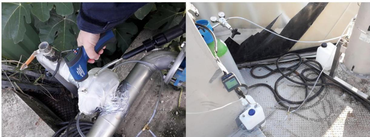
*Figure 3 : Mesures de quantification réalisées par bagging*
