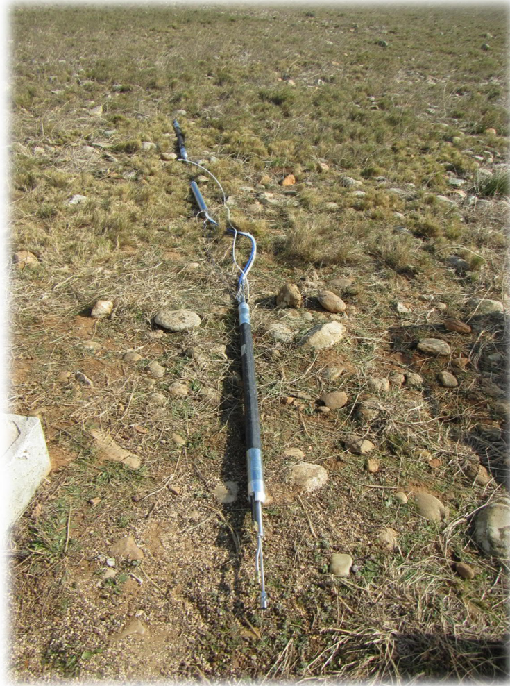
Figure 13 : Packers avec pompe à vessie (source : Ineris)
