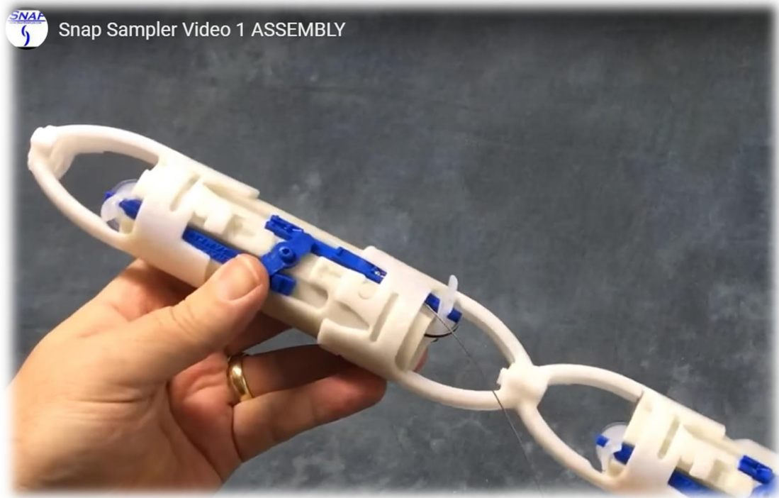
Figure 17 : Echantillonneur Snap Sampler composé de plusieurs bouteilles de prélèvements (source : http://snapsampler.com/ )
