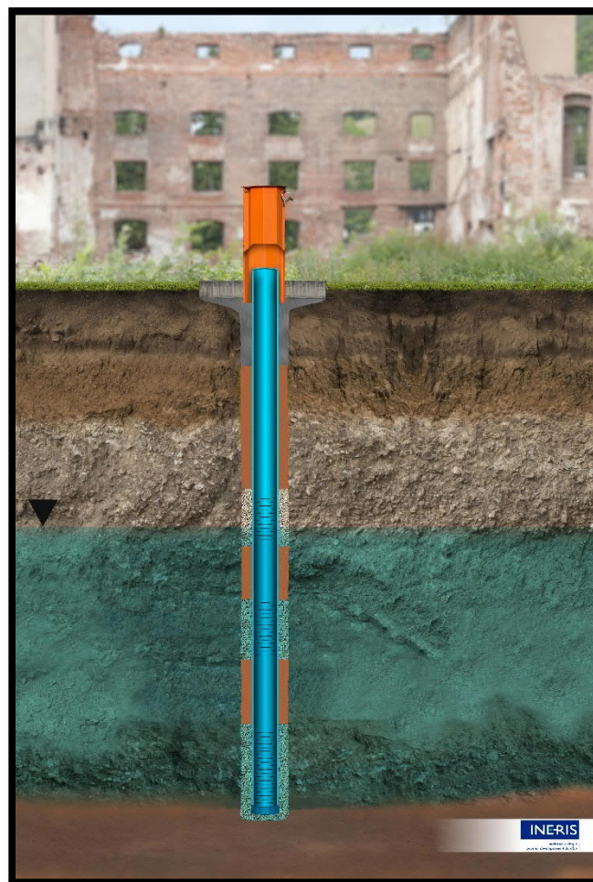
Figure 6 : Piézomètre crépiné sur plusieurs intervalles réduits (dit « sélectif »)
