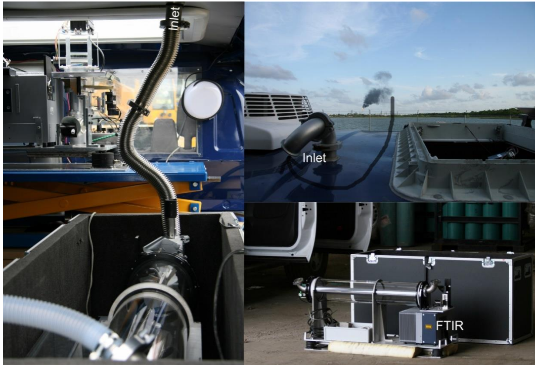
Figure 6: Montage du MeFTIR – unité mobile de mesure
