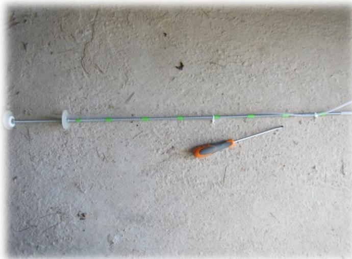
*Dispositif d'injection constitué d'un flexible accroché à une tige métallique et de deux joints étanches permettant de discrétiser le niveau d'injection*
