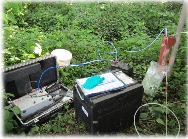
Figure 2 : Prélèvement d'eau souterraine à partir d'un piézomètre (ex. pompe pneumatique à vessie, Photo INERIS)
