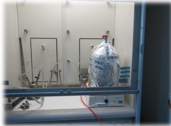
*Solution d'injection homogénéisée sous hôte aspirante*
