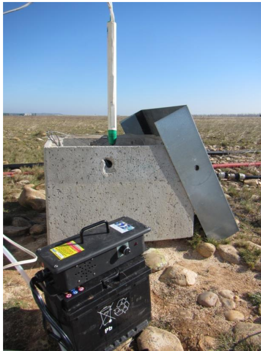
Figure 4 : Pompe PP36 avec système Low Flow utilisée sur un puits de la plaine de la Crau (INERIS)
