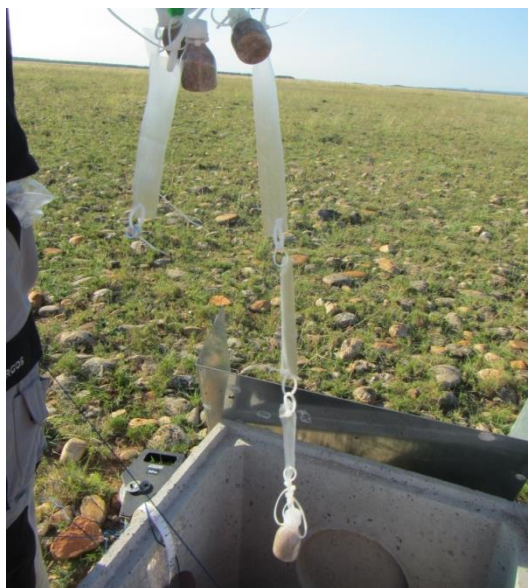
Figure 12 : Membranes de LDPE mises en place sur un puits de la plaine de la Crau (INERIS)
