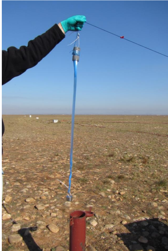
Figure 14 : Hydrasleeve™ type "SKINNY SuperSleeve 2" employé sur un piézomètre de la plaine de la Crau (INERIS)
