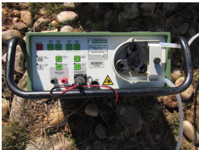
Figure 8 : Pompe péristaltique employée sur la plaine de la Crau (INERIS)
