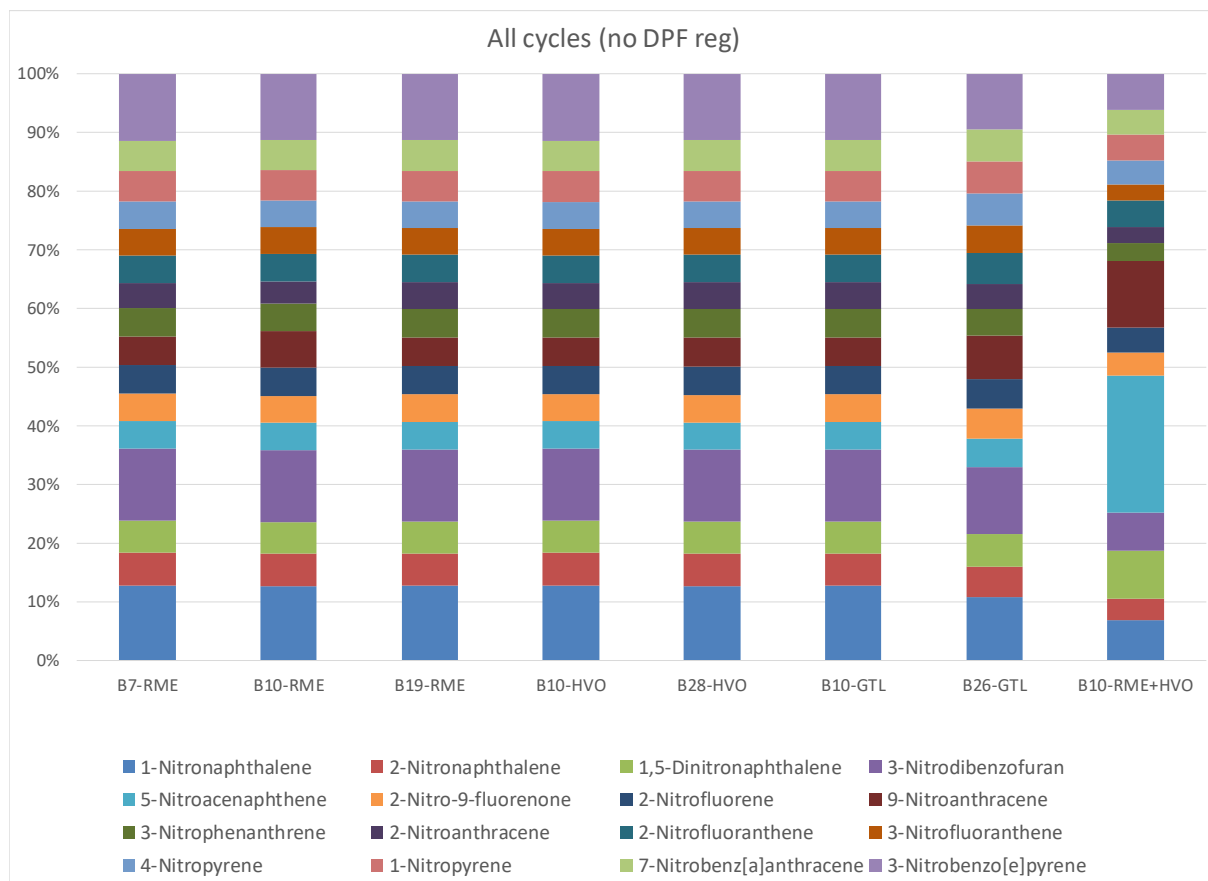
Figure 66 : Profils chimiques moyens en nitro-HAP particulaires selon la formulation du carburant (moyenne des essais réalisés n'incluant pas de phase de régénération du filtre à particules [no DPF reg.]
