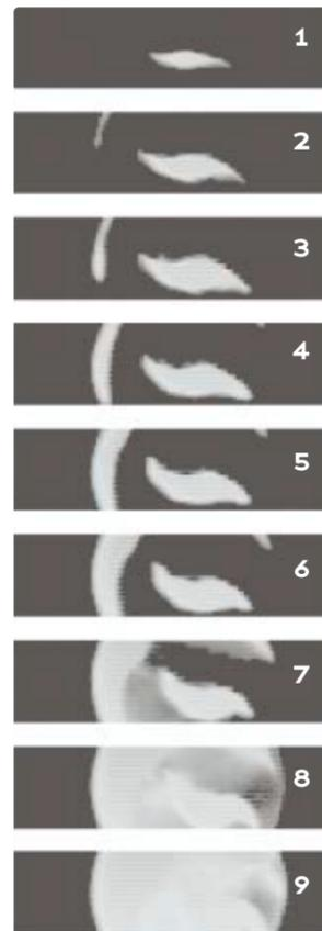
Développement d'une fissure sur une plaque (intervalle d'acquisition de  $10^{-4}$  secondes).
