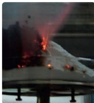
Amorçage de la combustion auto-entretenu du mélange fumigène (échantillon à 30 % de lactose, 30 % de féculé de pomme de terre et 40 % de KNO<sub>3</sub>).
