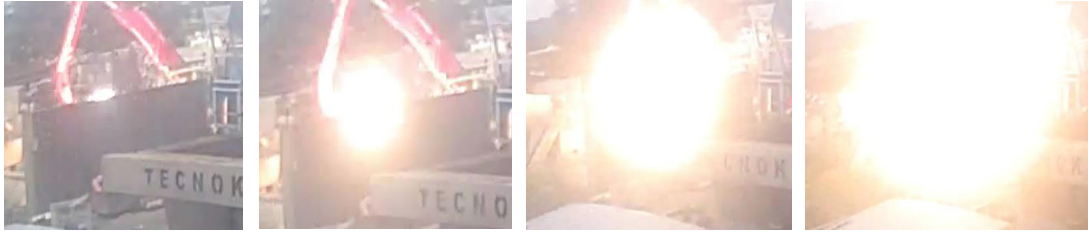
Figure 1 Développement de la boule de feu au niveau du tas d'aluminium
