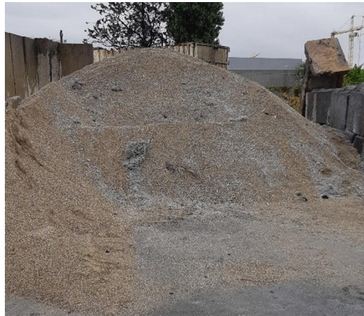
Figure 2 Tas d'aluminium brassé par les pompiers avec du sable
