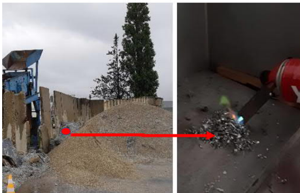
Figure 9 Réactivité à la flamme des échantillons 21AR079
