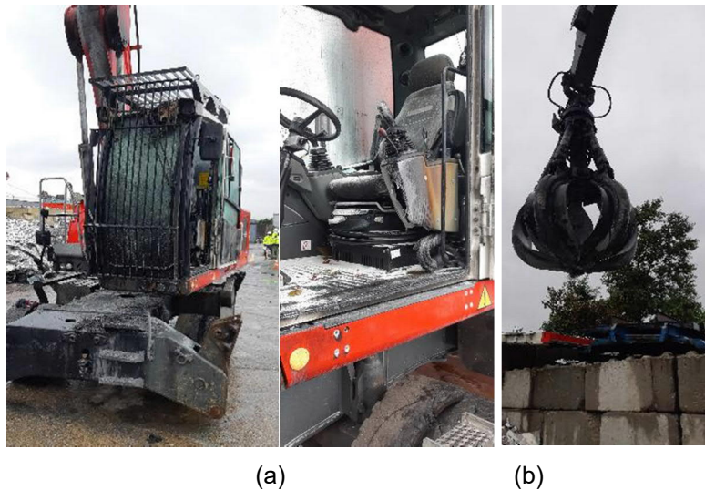
Figure 3 : Dégâts sur l'avant de la pelle à grappin (a) Dégâts sur le côté gauche de la cabine de la pelle à grappin (b) Grappin de la pelle
