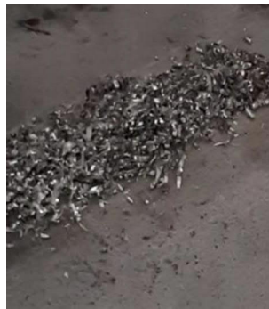
Figure 7 Copeaux millimétriques prélevés sur le tas d'aluminium
