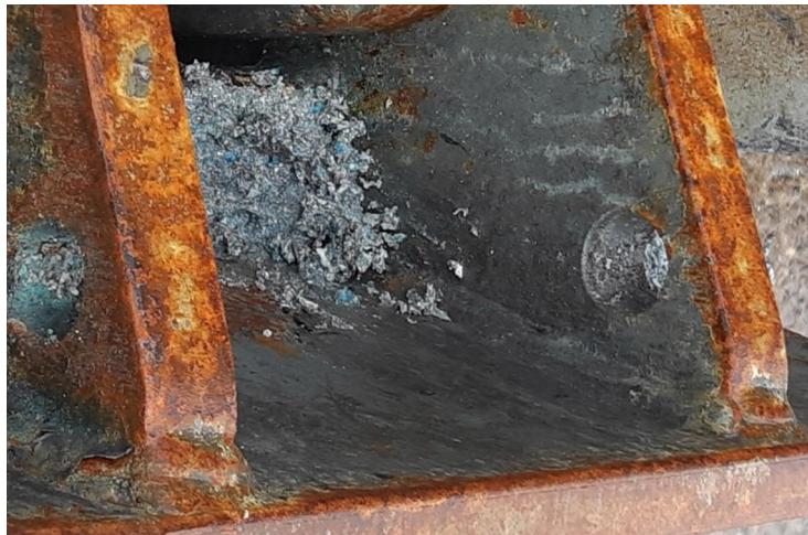
Figure 6 Zones bleutées observées sur l'échantillon 21AR082
