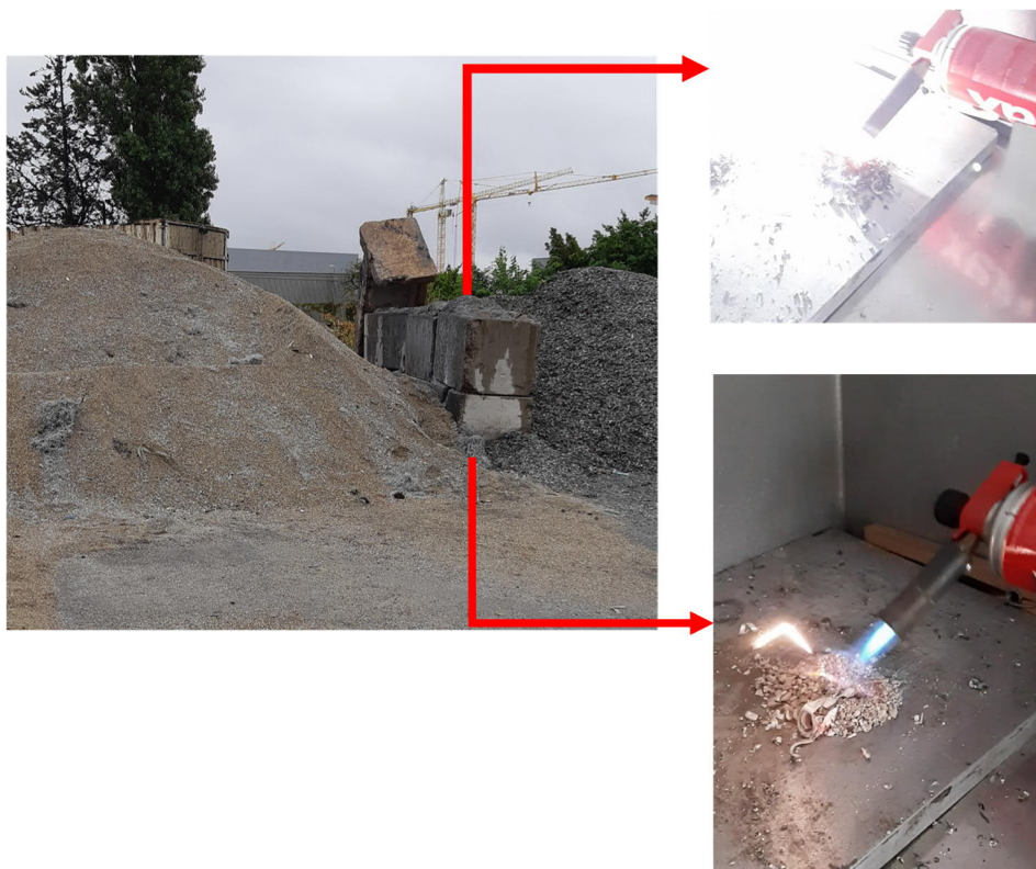
Figure 8 Réactivité à la flamme des échantillons 21AR078 et 21AR083
