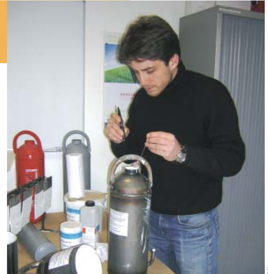
Solution simple et immédiate. Dubernard remplace le plomb des scellées de ses extincteurs par du polypropylène.
