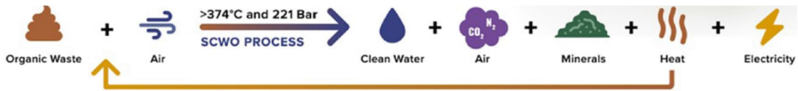
Figure 2 : Le procédé d'OESC dans le cas d'une minéralisation complète de la matière organique [extrait de Divine et al. (2023)].
