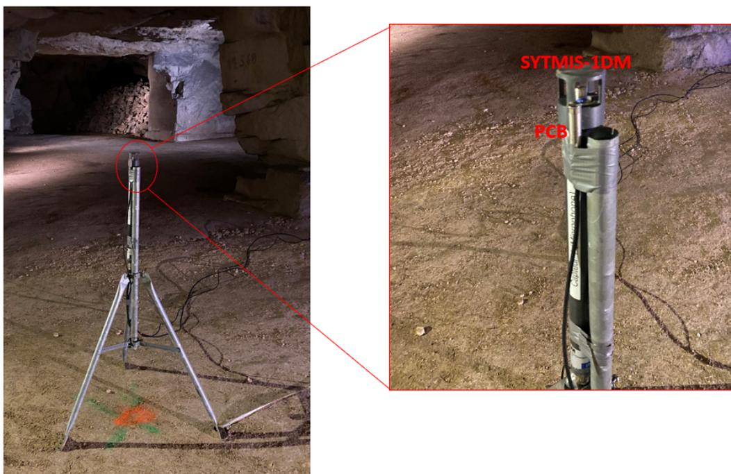
Photo 1 : installation des deux capteurs acoustiques : kit microphonique PCB et sonde SYTMIS-1DM l'un à côté de l'autre sur le même trépied.
