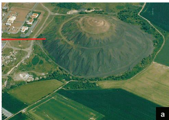
France : terril n°76 d'Avion en combustion en 1987 (a) et en 2002 (b) (Masalehdani et al., 2005)
