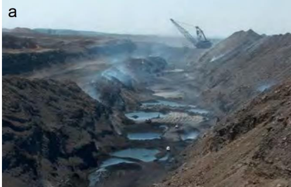
Afrique du Sud : Echauffement de terrils houillers (a : Phillips et al. 2009 ; b : Onifade et Genc, 2019)
