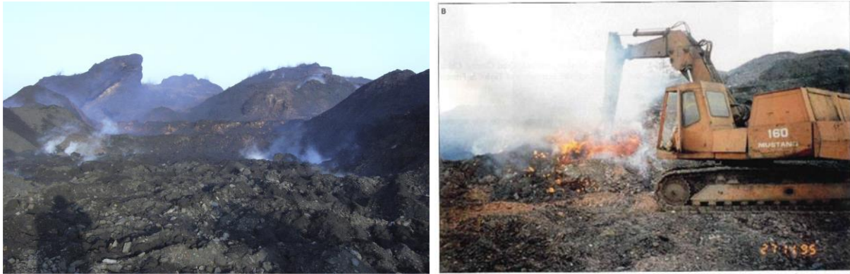
Creusement des terrils en combustion de la mine Marcel en Pologne (à gauche) et de Barnsley au Royaume-Uni (à droite) en vue de refroidir les résidus (Misz-Kennan et Tabor, 2015)
