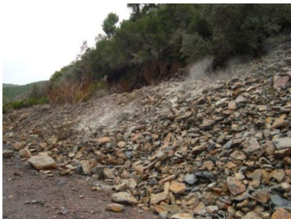
Espagne : terril d'Arroyo Galladas en combustion dans le bassin houiller d'El Bierzo (Ribeiro et al, 2019)
