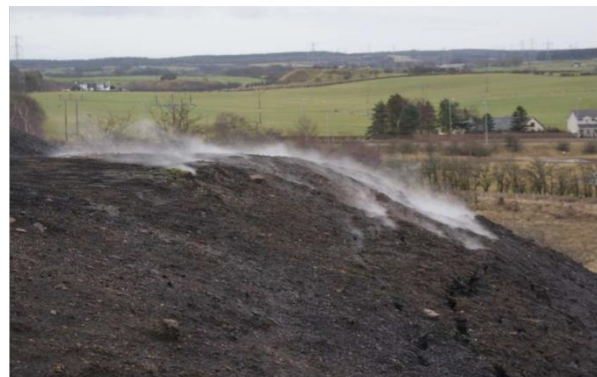
Royaume-Uni : terril de Bogsida en Ecosse avec sa partie brûlée (à gauche de la photo de gauche) et une vue de détail de la zone en combustion (photo de droite) (Torrance et al., 2012).
