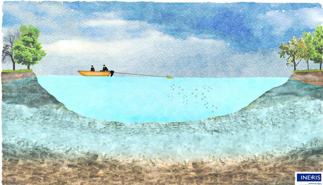
Figure 6 : C3PEaux - Recherche de microplastiques dans le milieu eau superficielle<sup>6</sup> à l'aide d'un filet Manta (avec ici filet trainé depuis une embarcation)
