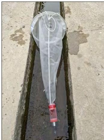
*Figure 4 : Prélèvement dans ruisseau canalisé (Marseille), filet à plancton
