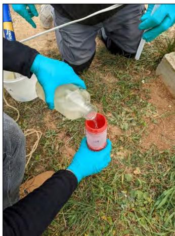
*Figure 5 : Prélèvement dans nappe d'eau souterraine (Aix en Provence), pompe immergée et collecteur
