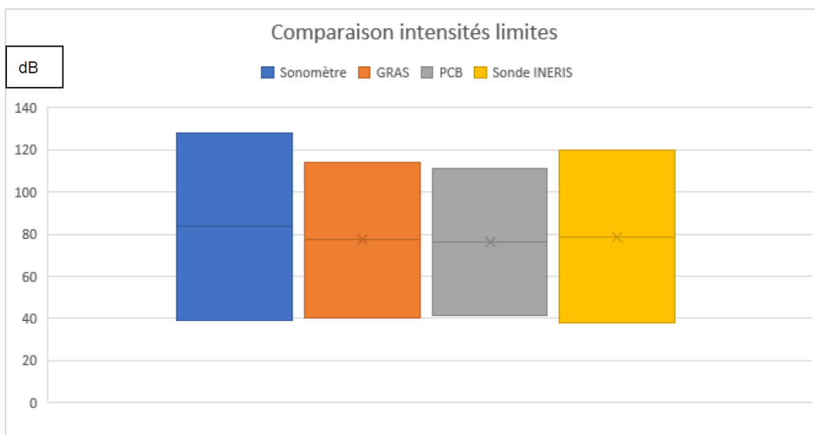
Figure 12 : niveaux de pression sonore en dB minimum et maximum perçus pour chaque kit microphonique, la sonde SYTMIS-1DM et le sonomètre
