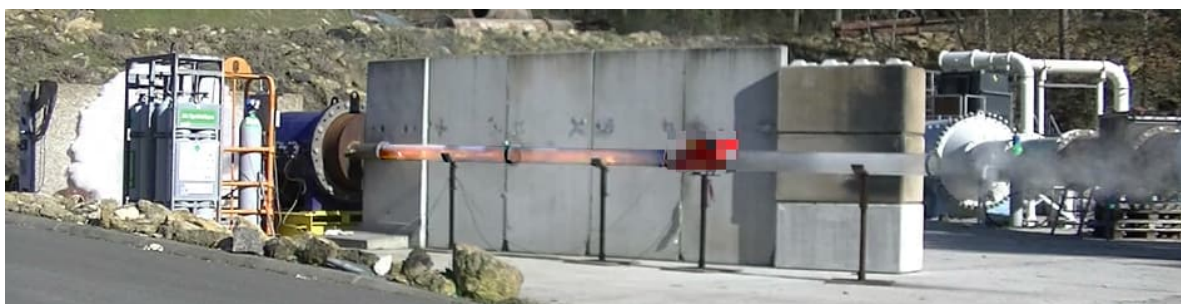
Figure 8 : Image de la caméra HD capturée pendant un test à l'Ineris de vanne à clapet d'isolation d'explosion. Clapet à 5 m d'une cuve de 1 m 3 , protégée par évent et dans laquelle un nuage de poussières de bois est enflammé. Le clapet est flouté pour des raisons de confidentialité.
