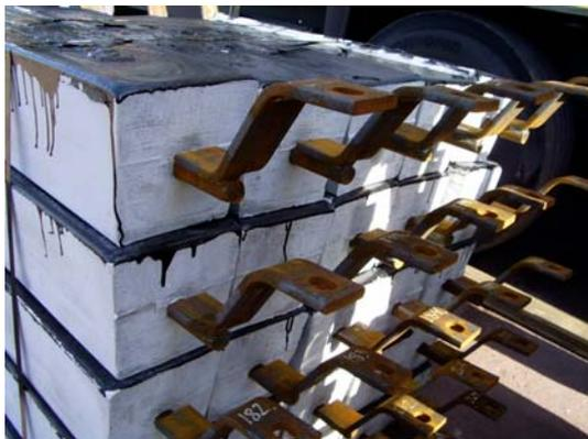
**Figure 7** Anodes sacrificielles
