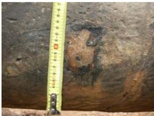
**Figure 4** Exemple de revêtement blessé sans toutefois aucune trace de corrosion après 50 ans.
