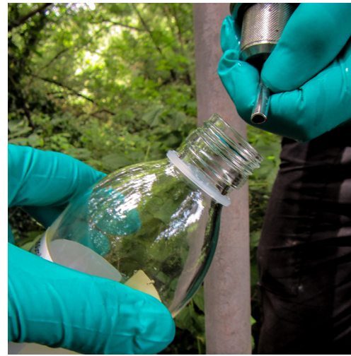
Figure 4 / Utilisation d'une pompe pneumatique à vessie afin de limiter le débit de prélèvement
