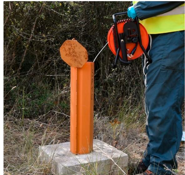
Figure 4 / Utilisation d'une sonde à interface
