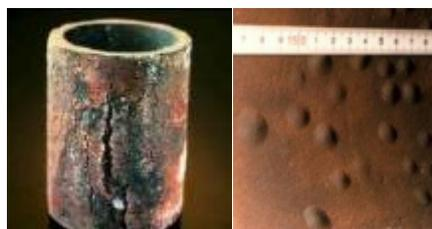
Figure 2 : Exemples de fragilisation : Fissuration sous hydrogène (à gauche) et cloquage par l'hydrogène (à droite)
