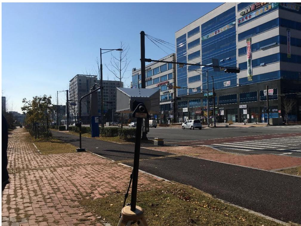
Figure 86 : Mesure avec l'antenne cornet Schwarzbeck / BBHA 9120 D
