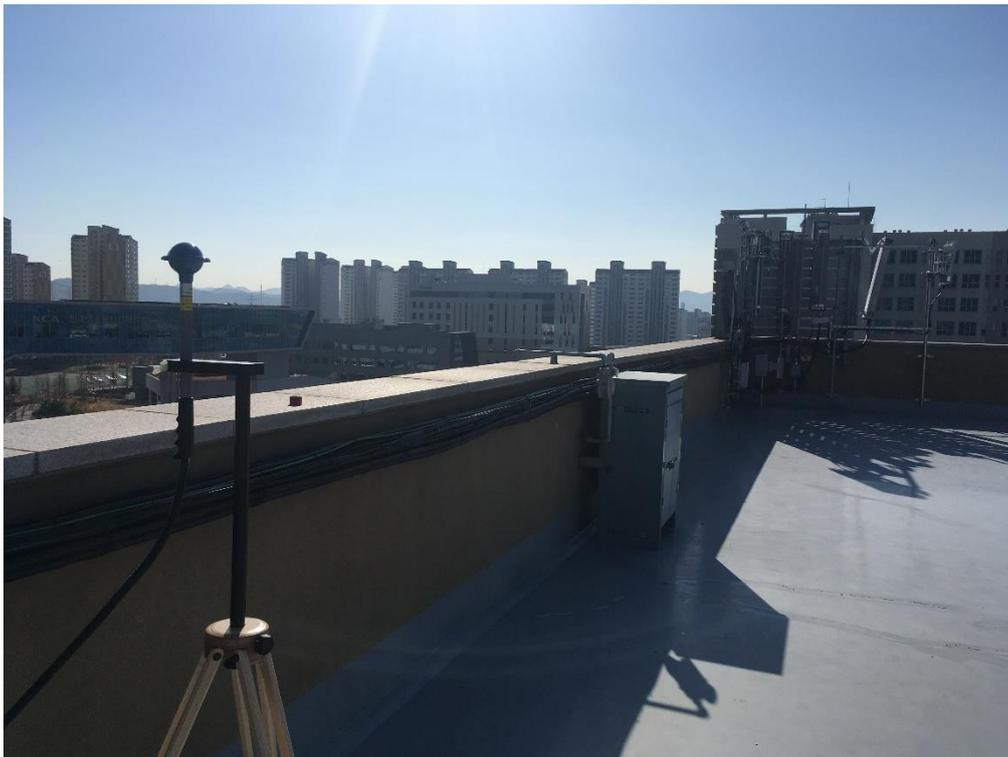
Figure 79 : Mesure avec l'antenne isotropique Satimo / TS\_EMF\_B2
