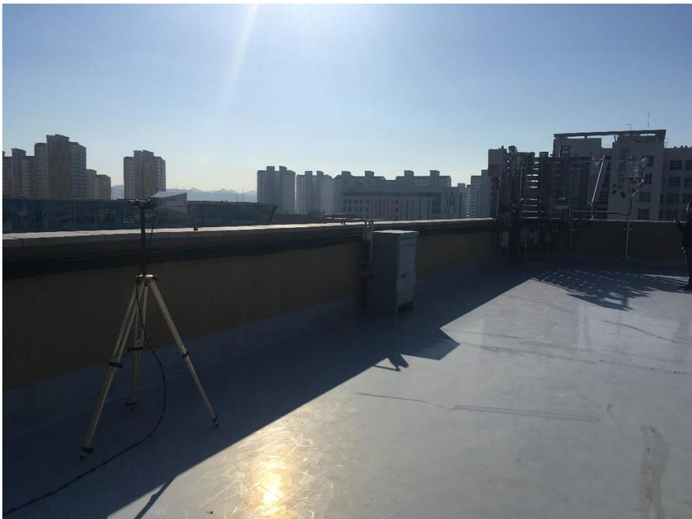
**Figure 78 : Mesure avec l'antenne cornet Schwarzbeck / BBHA 9120 D**
