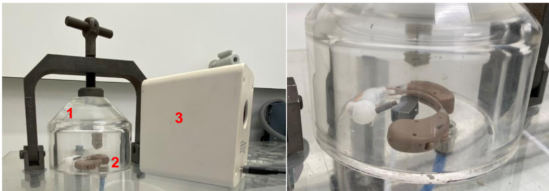
Figure 6 : Vue d'ensemble du banc d'essai : 1 - cloche en verre avec le mélange gazeux 2 - appareils sous la cloche 3 - enceinte Bluetooth
