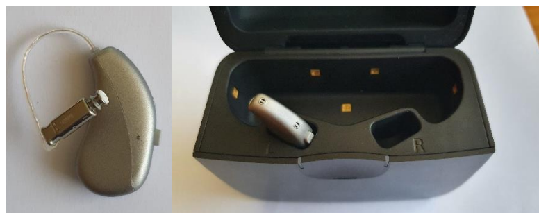
Figure 3 : Dispositif de recharge haut de gamme par induction – pas de borne exposée
