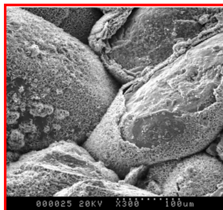
Figure 9 : Conséquence du vieillissement du minerai de fer (faciès ferrifère) : perte de cohésion des grains (photo MEB 4 )
