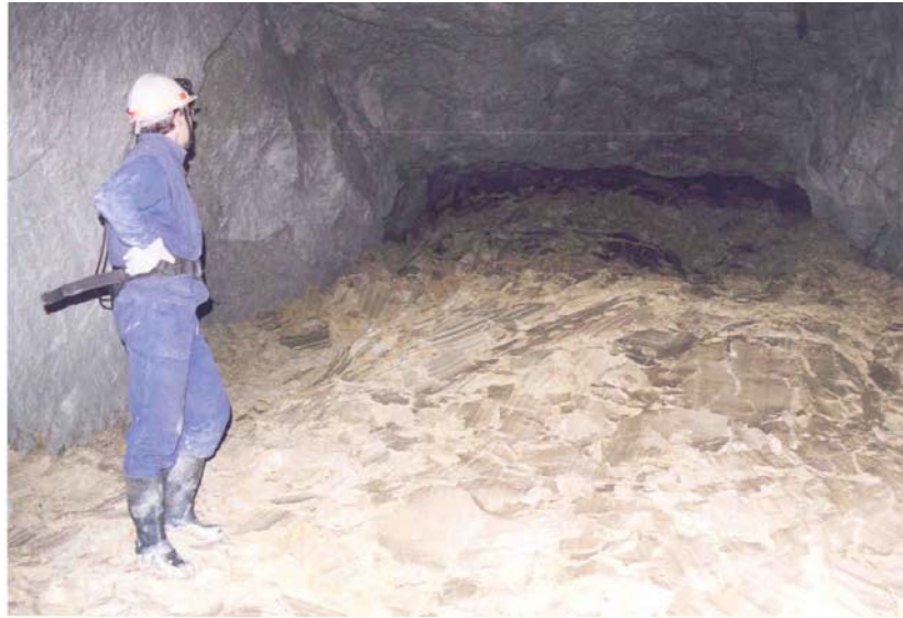
Photo 1 : Cône d'éboulis : à gauche, marnes sèche, à droite le même matériau sous l'effet de l'eau.
