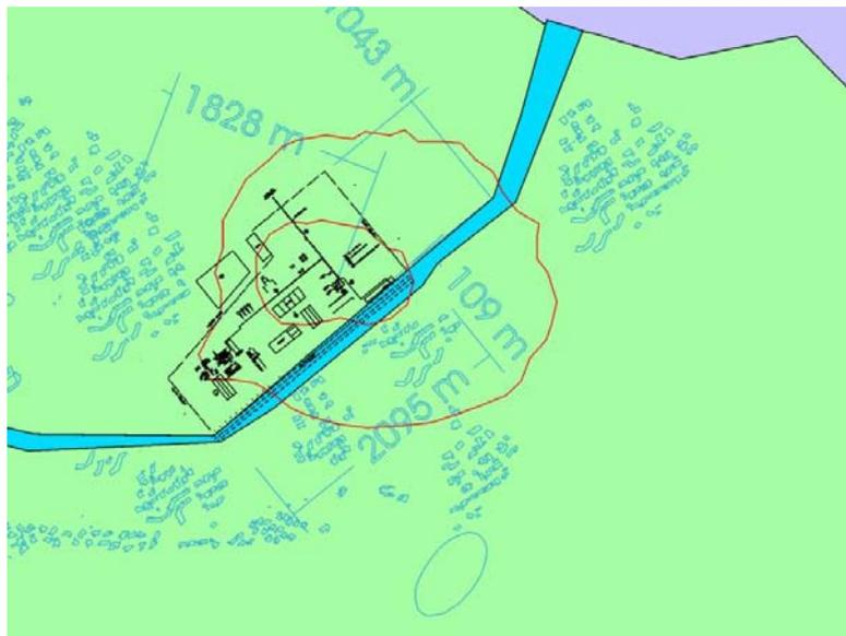
*Figure 5 : Variabilité des résultats dans le calcul du risque individuel – Minimum et maximum calculés pour la courbe d'isorisque  $10^{-5}$  /an*
