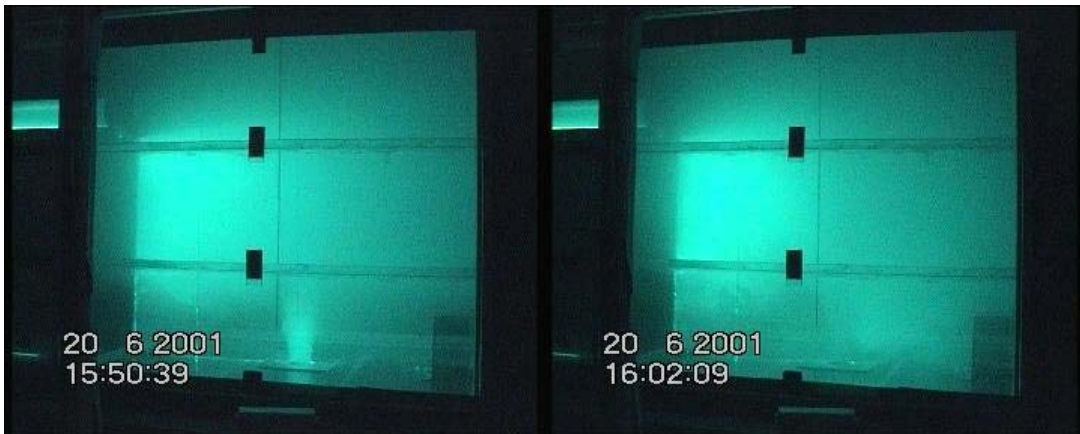
Photo 5—5 : Stratification durant l'état stationnaire de l'essai (gauche) et durant la ventilation de la cellule après arrêt de la source (droite) impliquant la destratification
