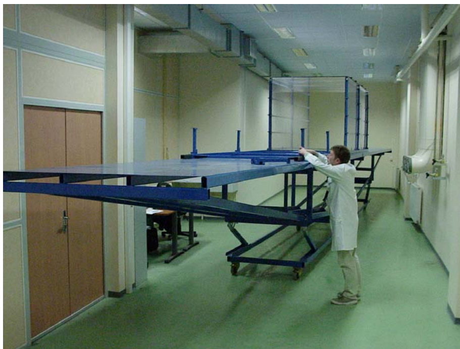
Photo 5—1: Vue d'ensemble du local maquette montrant le support maquette et le volume de dispersion tridimensionnelle composé de plaques translucides.
