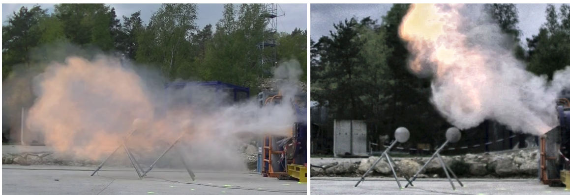
Figure 9 : Illustration de l'effet d'un déflecteur posé sur un événement d'explosion standard : à gauche événement sans déflecteur, à droite événement avec déflecteur, dans des conditions expérimentales identiques
