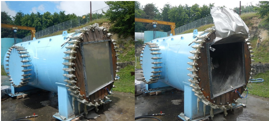
Figure 7 : Photographies d'un événement d'explosion standard de 1,1 x 1,1 m sur une cuve de 10 m 3 , avant et après une explosion confinée de poussières
