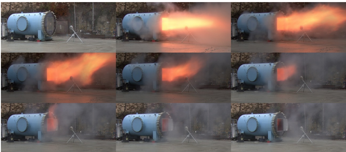
Figure 5 : Images de la décharge d'une explosion de poussières d'amidon de maïs par un événement d'explosion standard. La cuve est de volume 10 m 3 et l'événement de dimensions 1,1 x 1,1 m (400 ms entre les images).
