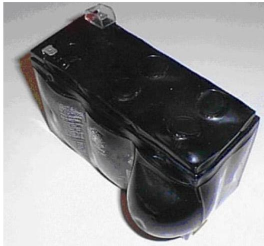
Figure 2 : Photographie d'une batterie VRLA déformée par une défaillance thermique<sup>16</sup>
