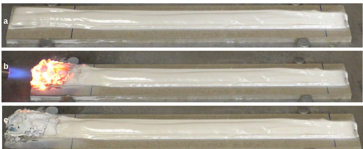
Figure 47 : Clichés photographiques du Produit 3 soumis à l'essai de propagation de l'épreuve N.1 avant essai (a), lors de la phase d'allumage (b) et en fin d'essai (c)
