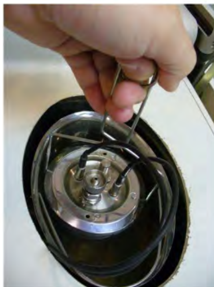
Figure 41: Positionnement de la bombe calorimétrique au sein du réservoir (source : Parr Instrument)
