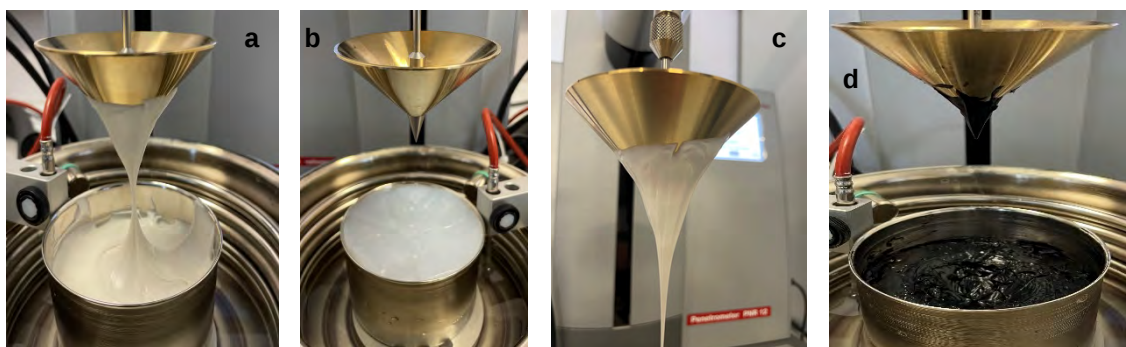
Figure 15 : Clichés photographiques en fin de test au pénétromètre lors du relevage automatique du mobile conique (NLGI) des produits 1 (a), 2 (b), 3 (c) et 4 (d)
