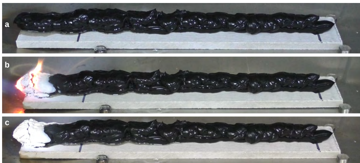
Figure 48: Clichés photographiques du Produit 4 soumis à l'essai de propagation de l'épreuve N.1 avant essai (a), lors de la phase d'allumage (b) et en fin d'essai (c)
