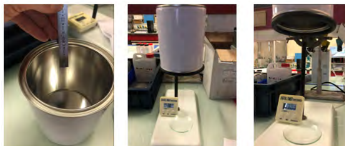
Figure 11 : Clichés photographiques de la réalisation d'un essai suivant la norme ASTM D 4359-90
