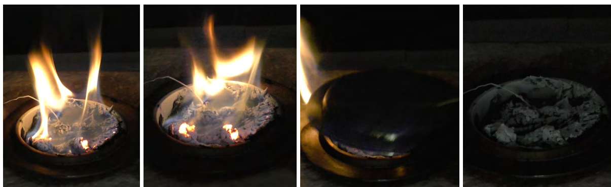
Figure 52 : Clichés photographiques du Produit 4bis au cours de l'essai de test passe/ne passe pas sur plaque chaude à 93°C
