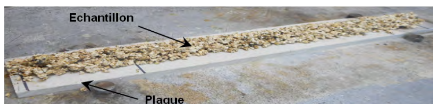
Figure 44 : Cliché photographique de l'échantillon déposé sur la plaque étanche, non combustible et de faible conductivité
