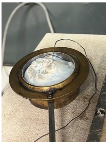
Figure 50 : Clichés photographiques du Produit 2 au cours de l'essai de test passe/ne passe pas sur plaque chaude à 93°C
