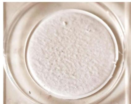
Détérioration des filtres par écaillage.
