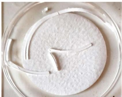
Détérioration des filtres par déchirement.
