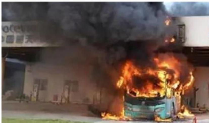
Figure 17 : Incendie d'un bus (Chine, 04/2015) dû à la défaillance du BMS pendant la charge
