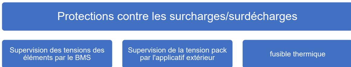
La supervision active de la tension de chaque élément par le BMS est un premier niveau de sécurité : le BMS peut ouvrir le contacteur pour déconnecter l'applicatif extérieur dès que la tension d'un élément dépasse un seuil critique haut (surcharge) ou bas (surdécharge).
