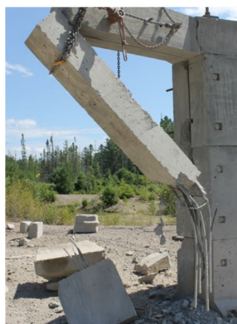
Figure 1. Essai d'explosion et comportement de la structure [Siba, 2014]
